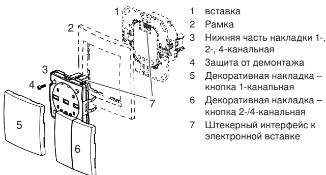
Рис. 4: Монтаж на примере KNX-Радио
