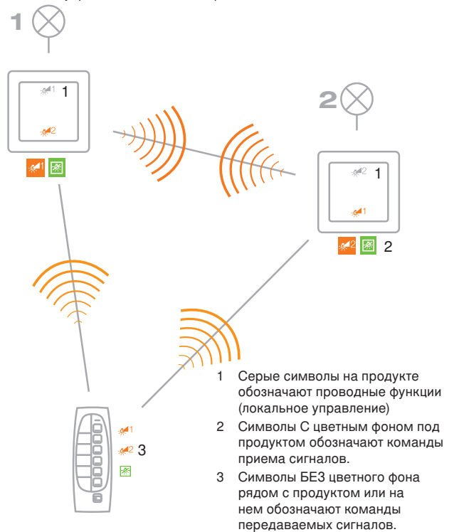
Рис. 15: Пример конфигурации передатчик/приемник
