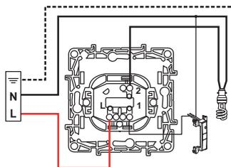
Указанный способ подключения предотвращает мерцание энергосберегающих ламп в выключенном состоянии.
