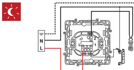
Указанный способ подключения предотвращает мерцание энергосберегающих ламп в выключенном состоянии.
