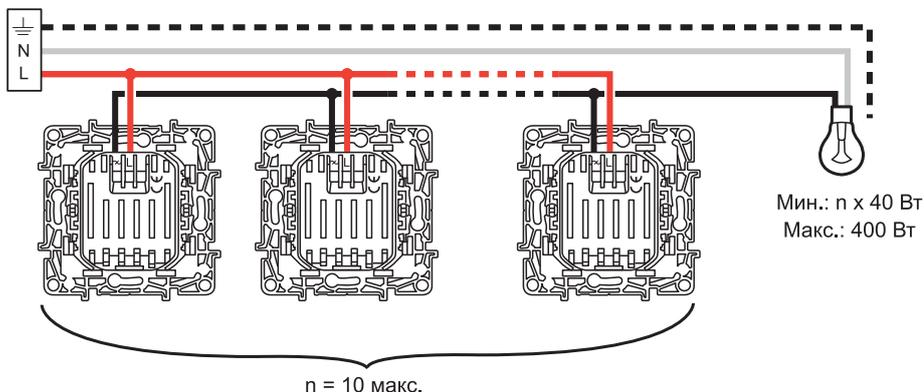
■ Схема подключения датчика движения и выключателя без фиксации (кнопки) с Н.О./Н.З контактом (Кат. № 6 72X 14) для обеспечения принудительного включения датчика
