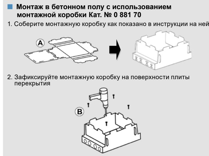
2. Зафиксируйте монтажную коробку на поверхности плиты перекрытия
