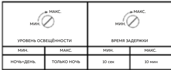
Рис. 6. Увеличенный вид потенциометров порога освещённости и времени задержки отключения.
