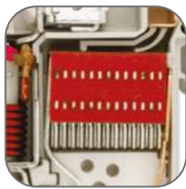
Дугогасительная камера с 13 пластинами
