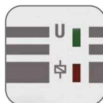
Индикация состояния питания и реле
