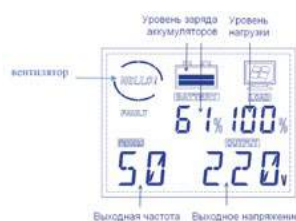
Индикация дисплея в батарейном режиме
