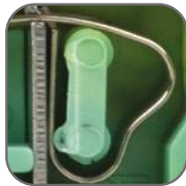
Токоведущая пластина выполнена из луженой меди
