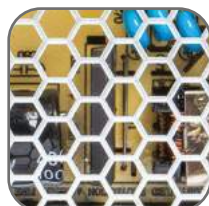
Вентиляционные отверстия для луч- шего теплоотвода
