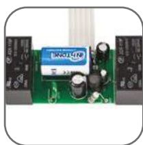
Два встроенных реле на токи до 8 А
