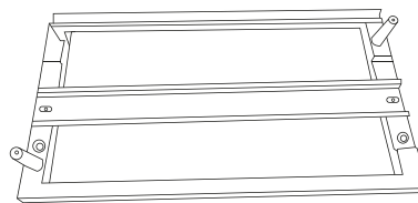
1. Монтажная рама (крепится к стене четырьмя саморезами и дюбелями)
