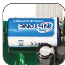
Часы реального времени работают 10 лет без питания
