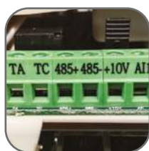
Встроенный интерфейс RS485
