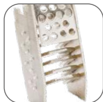
Однородные по толщине и массивные пластины – лучшие условия гашения дуги
