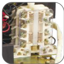
Дополнительные контакты в базовой комплектации
