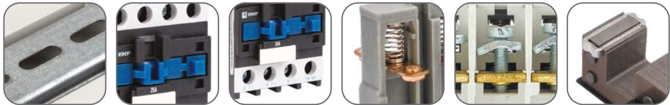
Установка на DIN-рейку и на монтажную панель | Наличие доп. контактов для организации автоматизации | Маркировочная площадка в комплекте | Мостиковый контакт создает условия для быстрого гашения дуги | Тарельчатые зажимы для надежного присоединения проводников | Сердечник магнитной системы с уменьшенными вихревыми потерями
