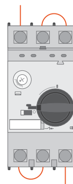
Подключение однофазного двигателя
