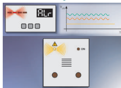
Традиционное устройство контроля изоляции
