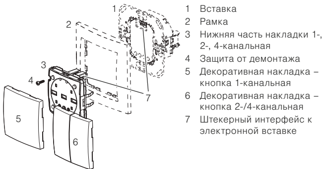
Рис 1: Монтаж на примере радиопоины KNX
