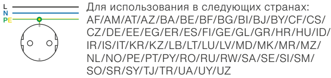
Рис. 1. Розетка SCHUKO* с 2 полюсами + заземление, 250 В ~ , 16 А
