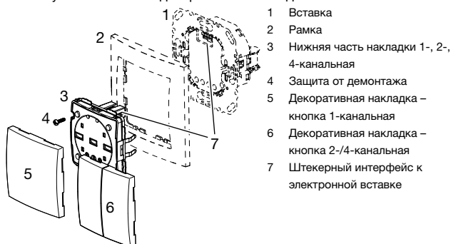
Рис 1: Монтаж на примере радиوشины KNX
