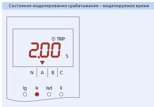
Состояние моделирования срабатывания – моделируемое время
