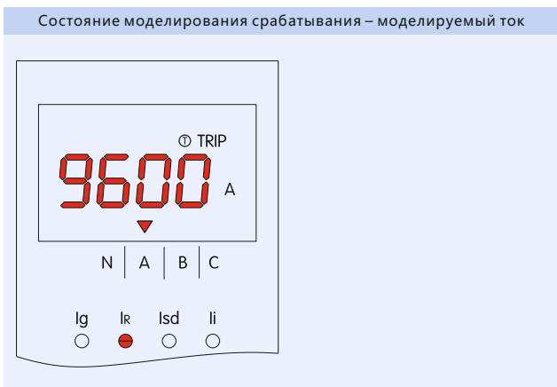
Состояние моделирования срабатывания – моделируемый ток
