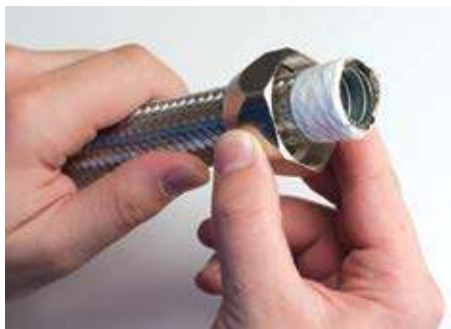
1. Вначале следует надеть на металлорукав зажимную гайку
