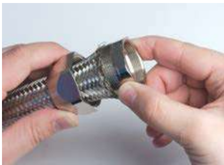
2. Установить промежуточный корпус под оплетку, предварительно удалив скотч с металлорукав. Плотнo зафиксировать гайку и промежуточный корпус между собой, тем самым закрепив оплетку металлорукав в аксессуаре
