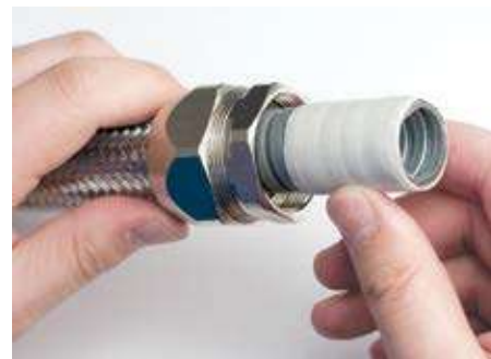
3. При использовании металлорукав в гладкой оболочке – перейти к пункту 4. При использовании герметичного металлорукава необходимо накрутить на край уплотнительную муфту для металлорукава (белого цвета) для получения герметичного соединения. Совет: сдвиньте оплетку от края для удобства монтажа уплотнительной муфты
