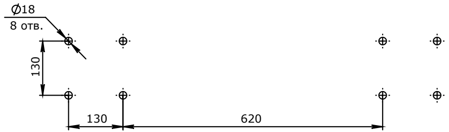
Присоединительные размеры двустоечной колонны
