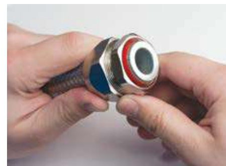
6. Сдвиньте гайку, промежуточный корпус и уплотнительное кольцо на край металлорукава
