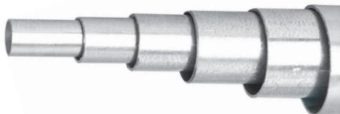
В состав системы "Cosmes" включены два вида труб: оцинкованные трубы и трубы из нержавеющей стали. Металлические трубы, оцинкованные по методу Сендимира, отличаются высокой механической прочностью и применяются там, где необходима надежная защита кабеля от внешних воздействий. Жесткие трубы также незаменимы при прокладке электропроводки внутри горючих оснований, при строительстве деревянных домов и реконструкции горючих перекрытий, прокладке на чердаках и в подвалах.
