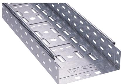
Перфорированные лотки удобнее монтировать на консоли, используя для крепления перфорированные отверстия в лотках. Также благодаря перфорации в лотке не скапливается конденсат и обеспечивается вентиляция кабеля.
