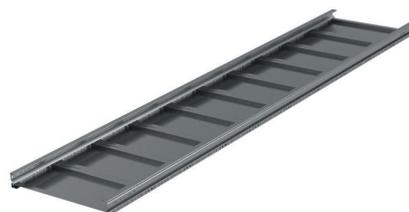
**Листовой неперфорированный лоток** имеет конструкцию, аналогичную предыдущему, но при этом везде отсутствует перфорация. Данный тип лотка применяется в промышленности для большей защиты, где вместе с электрическими линиями проложены коммуникации (трубы с водой, газом и т. п.).
