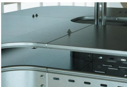
Крышки лотков и аксессуаров соединяются между собой внахлест, а на лоток крепятся простым защелкиванием без дополнительных приспособлений. При монтаже крышки используется винт М5 с выделенным символом заземления, при этом гайка уже заштампована в крышку (для удобства при монтаже надежного и качественного соединения). Такие особенности конструктивного исполнения крышек ДКС исключают необходимость прокладки дополнительного заземляющего контура.
