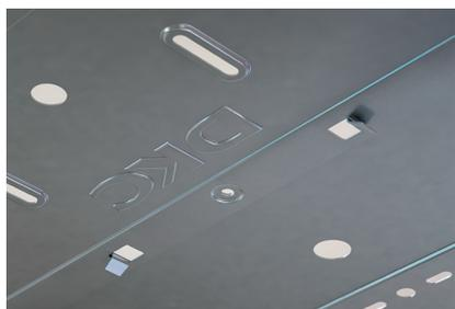
Специальные "лепестки" на дне листового лотка "S5 Combitech" служат для быстрой предварительной фиксации линии лотков. При организации трассы лотки стыкуются между собой при помощи соединения "папа-мама". "Лепестки" подгибаются в соответствующие отверстия на ответной части лотка. Далее остается только применить необходимые крепежные элементы для соединения лотков.
