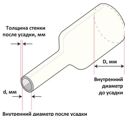
Наиболее важные технические характеристики для выбора трубки – их диаметры до и после усадки.
