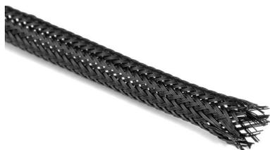
Выполняет те же функции, что и жгут Spiralite, но в отличие от него все проводники протягиваются внутри оплетки, обеспечивая презентабельный вид. Впоследствии, при продольном вытягивании, оплетка уменьшается в поперечном сечении, что обеспечивает плотный обхват проводов.
