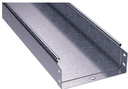
Неперфорированные лотки применяют для объектов, где требуется закрытый конструктив кабельной трассы для обеспечения высокой степени пыле- и влагозащиты. Система позволяет организовать степень пыле- и влагозащиты до IP44 по ГОСТ 14254-2015 при условии применения специальных уплотнительных элементов. Для одного стыка необходимо 4 резинопластиковых уплотнителя и 4 металлических пластины, которые обеспечивают плотное прилегание уплотнителя.
