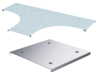
**Крышка для лотка** имеет усиленный замок. Крышка может быть либо гладкой стальной, либо рифленой алюминиевой.
