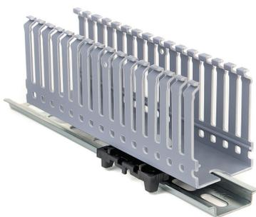
Если щит имеет рамную конструкцию (нет общей панели, на которую крепится оборудование), то, как правило, в таком щите все оборудование крепится на стандартизированные металлические профили DIN-рейки. При монтаже перфорированного короба на DIN-рейку необходимо защелкнуть специальный суппорт DINBLOCK на DIN-рейку, а затем зафиксировать перфоркороб с помощью специальных крепежных элементов ZP1.
