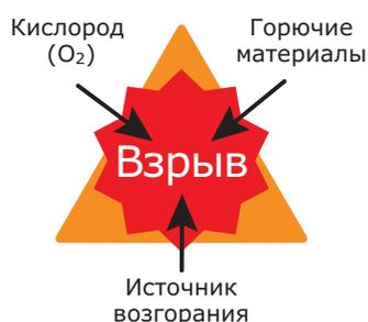
Максимальная температура нагрева поверхности электрооборудования всегда должна быть ниже температуры самовоспламенения горючих паров и газов. Температура самовоспламенения горючих паров или газов – это минимальное значение температуры, при которой горючие пары и газы могут вспыхнуть.
