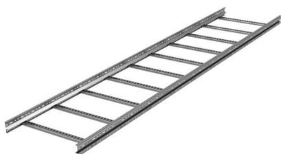
**Лестничный лоток** представляет собой два перфорированных лонжерона (борта), соединенных между собой траверсами (ступенями). Лоток обладает небольшим собственным весом, что удобно для транспортировки и монтажа.
