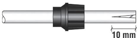
1. Наденьте колпачок на кабель, после чего срежьте внешний слой изоляции.
