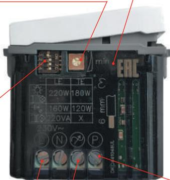
Клемма P подключения внешней кнопки управления для включения освещения на выставленном диммером уровне
