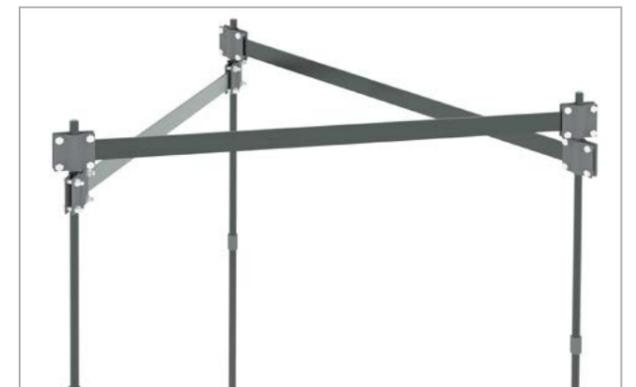
**Шаг 8.** Зажим gc-g3116 №7 устанавливается на полосу 4×40 в составе треугольника в свободном месте и к нему подключается проводник. Места соединения рекомендуется обработать защитной смазкой и обмотать антикоррозионной лентой.
