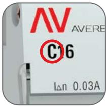
**C** – выключатель сработает между 50- и 10-кратными значениями номинального тока. Рекомендуется к установке в сетях со смешанной нагрузкой, предполагающей умеренные пусковые токи (гражданское строительство, офисные помещения).
