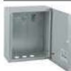
60041654 ЭРА SIMPLE ЩМП-03 IP31 (360x300x175) 230 / 400В, ≤400 А, IP31, УХЛ3, навесной, 250x300x175 мм, сталь, полиэфирная порошок. краска, цв. серый, RAL 7035
