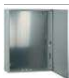
60047606 ЭРА SIMPLE ЩМП- 4-0 76 УХЛ3 IP31 (800x600x240) 230 / 400В, ≤400 А, IP31, УХЛ3, навесной, 800x600x240 мм, сталь, полиэфирная порошок. краска, цв. серый, RAL 7035
