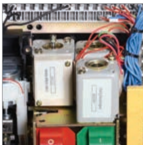
Независимый расцепитель, минимальный расцепитель и катушка включения
