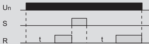
Диаграмма работы реле задержки включения ORT-A
