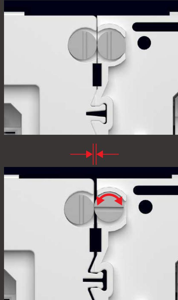
позволяет регулировать зазоры вращением эксцентрика
