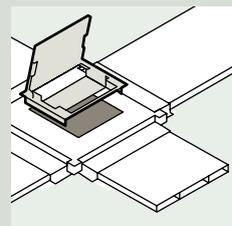
Металлические коробки и напольные кабель-каналы идеальны для бетонных полов
