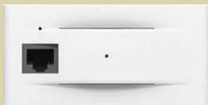
Точка доступа Wi-Fi (802.11 a+b/g двухдиапазонная) с розеткой RJ 45. Обеспечивает безопасное беспроводное подключение с возможностью выполнения проводного подсоединения. Небольшие габаритные размеры (4 модуля) без подключения к сети 230 В≈ (питание P.O.E.\*)
