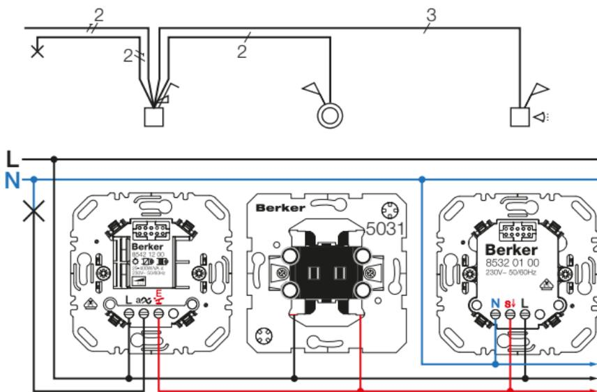
**Рис 2:** Универсальный нажимной диммер одинарный с кнопкой (размыкатель) и дополнительное устройство для датчика движения
