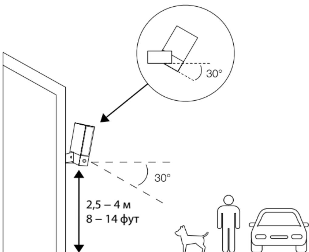
Для оптимальной производительности установите устройство на высоте от 2,5 до 4 метров и наклоните под углом примерно  $30^\circ$ .
