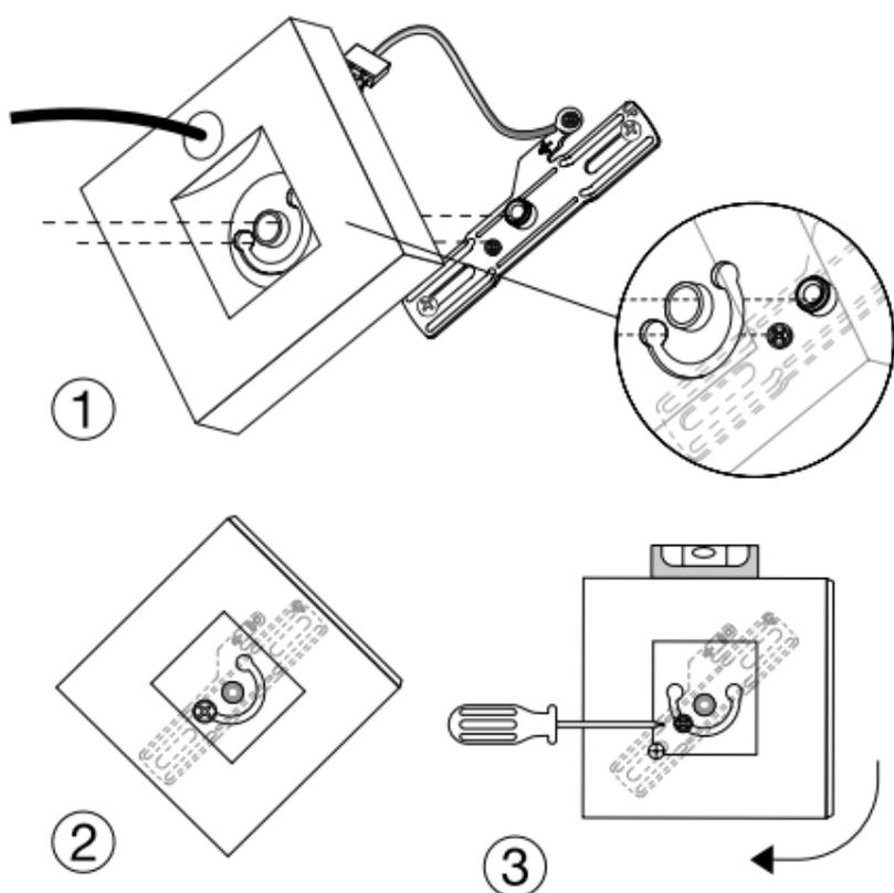
**Закрепите панель на монтажной планке.**
