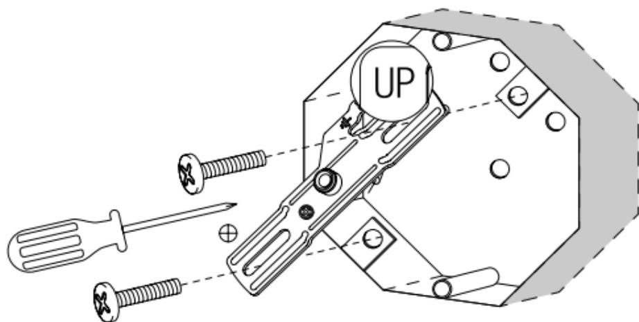
Закрепите в распределительной коробке монтажную планку.
