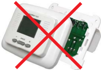
Рис. 9а Неправильное снятие крышки прибора
