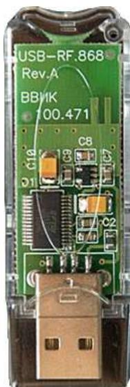
USB-RF адаптер предназначен для настройки, диагностики и сервисного обслуживания устройств со встроенными RF-модемами.
