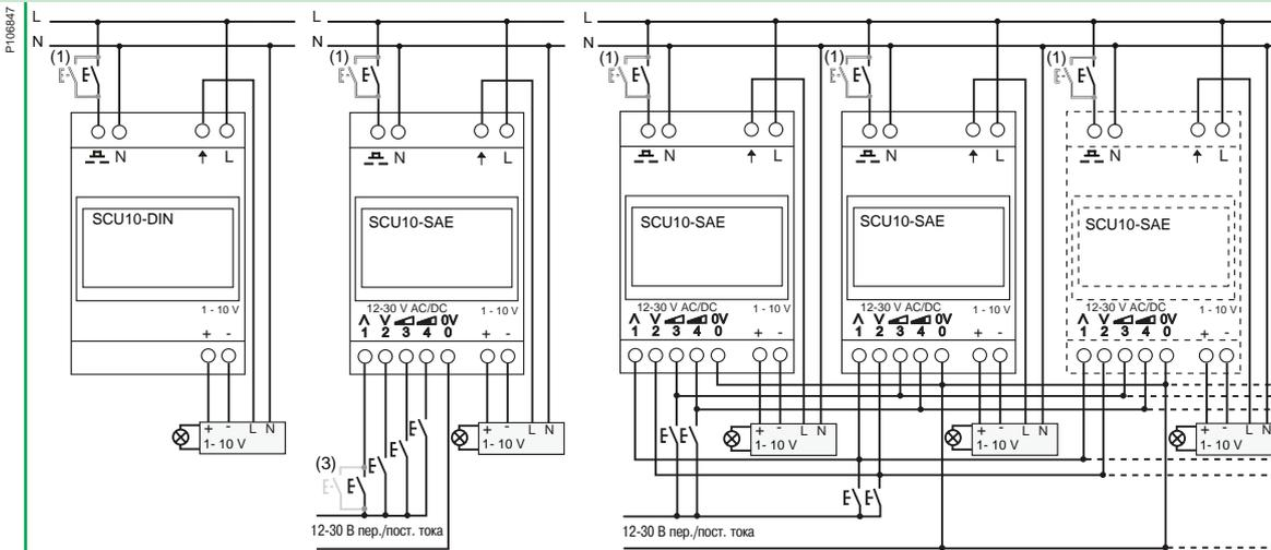
Для диммеров типа SAE: с помощью одной кнопки можно управлять группой, объединяющей до 20 диммеров моделей STD400RC/RL-SAE, STD1000RL-SAE и SCU10-SAE через их четыре дискретных входа
