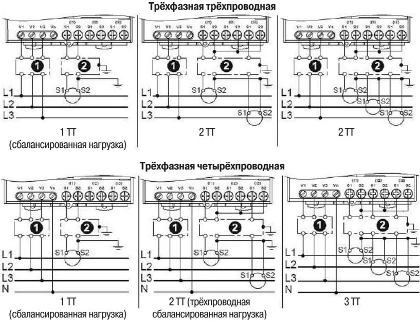
**Примеры подключения счётчиков серии iEM32xx (iEM3250 и iEM3255) к трёхфазной электросети с трансформаторами напряжения**
