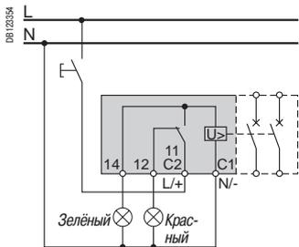
Управление замыкающей кнопкой с проверкой наличия напряжения (iMX+OF)
