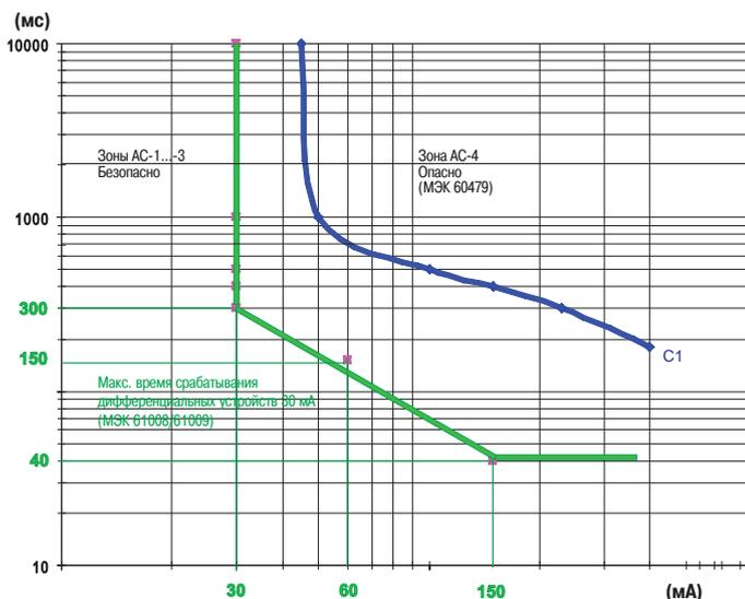
■ В технической части стандарта МЭК 60479 анализируется чувствительность человеческого тела к электрическому току. Кривая с1 определяет, для каждого значения тока, максимальную продолжительность действия тока до возникновения опасности травмирования человека.
