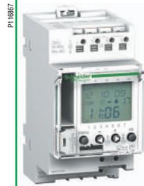
IC 100kp+ 1C/2C управляет освещением исходя из уровня освещенности и времени суток. Выходной контакт замыкается и освещение включается, когда уровень освещенности падает ниже заданной уставки (функция переключения по уровню освещенности), а размыкается – по программе (функция переключения по времени).
