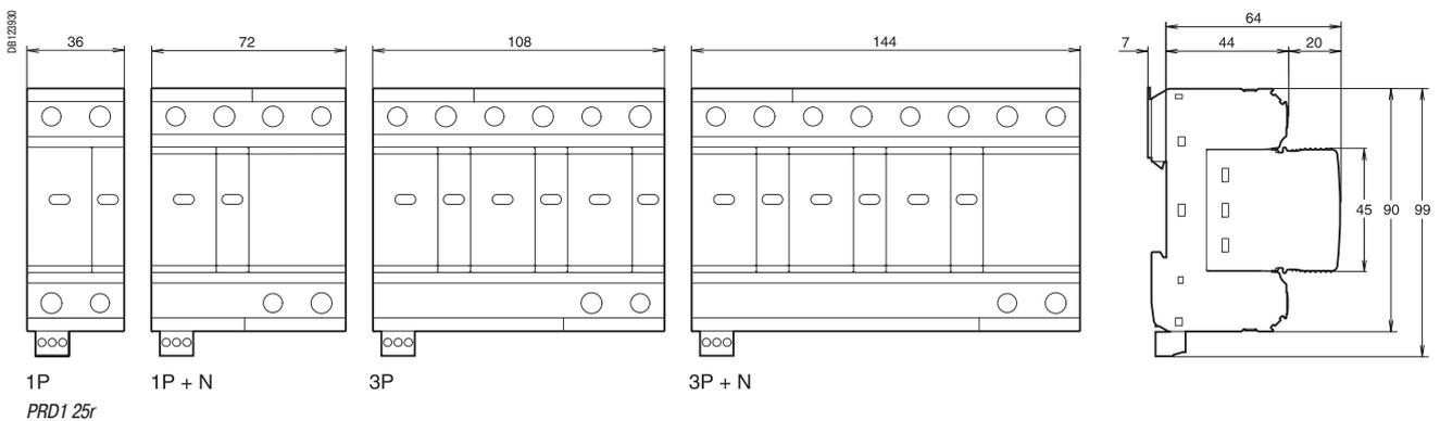
Обычные аппараты защиты не в состоянии отключать импульсы перенапряжения, а это очень опасно, прежде всего для электроприборов и электроники, которые могут моментально выйти из строя. Для этой цели применяются УЗИП. Устанавливаются данные устройства параллельно нагрузке, причем защищать следует и фазу и "нейтраль".
