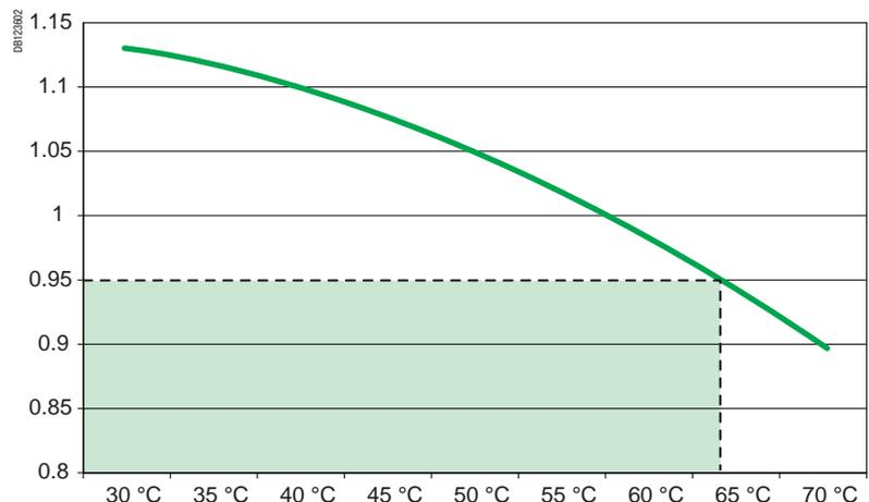
Если температура достаточно высока, и порог срабатывания может стать ниже рабочего тока  $I_B$ , следует предусмотреть вентиляцию распределительного щита.
