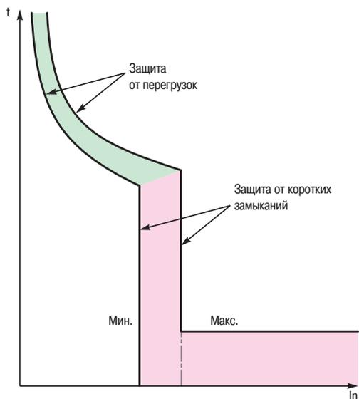
Приведённые ниже кривые отображают общее время отключения тока повреждения в зависимости от его силы. Пример: автоматический выключатель iC60 (кривая С, номинальный ток 20 А) отключит ток 100 А (то есть 5-кратный номинальный ток  $I_n$ ) за:
