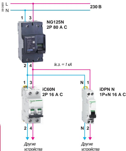
Вышестоящий аппарат: NG125N 80 А 2Р, кривая С; нижестоящий аппарат: iC60N 16 А 2Р, кривая С. Напряжение сети: 230 В между фазой и нейтралью.
