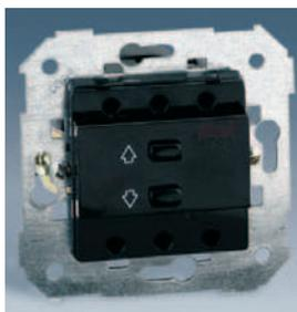
**75358 -39** ИК-приемник для управления жалюзи напряжение 230 В- 50 Гц максимальная мощность подключаемых устройств 700 Вт возможно применение совместно с артикулами 75331-39, 75396-39 или 75820-39 для централизованного управление жалюзи
