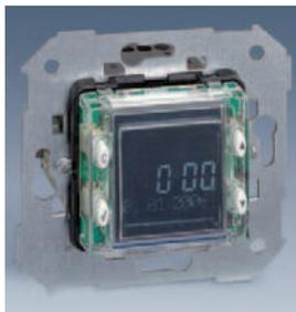
**75820 -39** Механизм с программным управлением работы жалюзи с ЖК-дисплеем напряжение 230 В- 50 Гц программирование открытия / закрытия жалюзи возможно применение совместно с артикулом 75858-39 для централизованного программирование работы жалюзи по времени имитации присутствия переход "лето-зима" релейный выход 5 А ( 1 А) / НО контакт
