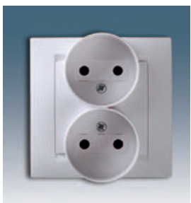
1590457 -030 -031 -032 -033 -034 -036 Розетка двойная без заземления 2x2P, 16 А, 250 В, винт. зажим
