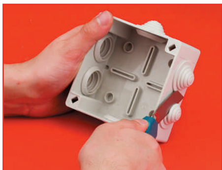
1 этап. Срезаем кабельный ввод
