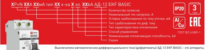
Выключатели автоматические дифференциального тока (дифавтоматы) АД-12 EKF BASIC – это аппараты, сочетающие функции автоматического выключателя с устройством защитного отключения. При обнаружении автоматическим выключателем в защищаемом участке сети тока утечки (повреждения) на землю или сверхтока (тока перегрузки или короткого замыкания) происходит срабатывание устройства, приводящее к отключению защищаемой сети.
