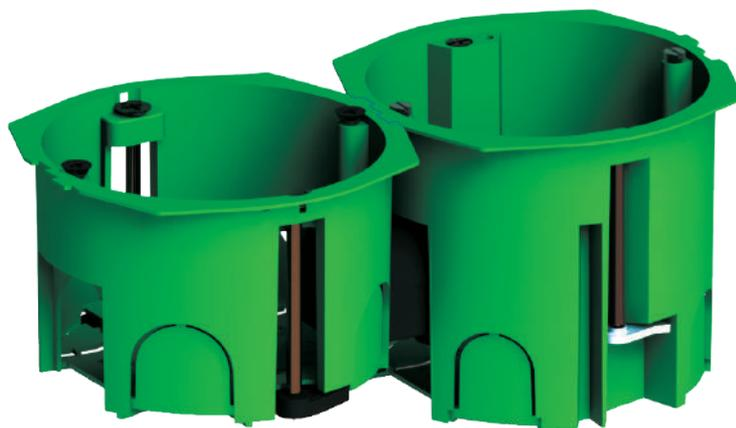
Для установки в полых стенах многопостовых электроустановочных изделий монтажные коробки соединяются между собой. Для этого используют кабельные переходники ПК5201 и ПК5202 (см. раздел «Аксессуары»). Благодаря им можно состыковать между собой в ряд любое количество коробок, выдерживая межцентровое расстояние 71 мм.
