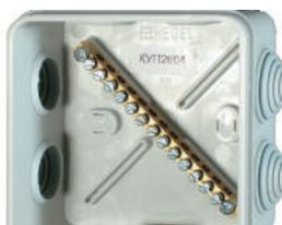
Материал шин – латунь без покрытия. Сечение шины – 6x9,2 мм. Контактные винты обеспечивают надежный контакт шины с проводами с цельнотянутой жилой. А проводники с многопроволочной жилой необходимо предварительно или облудить или обжать трубчатым наконечником соответствующего сечения.
