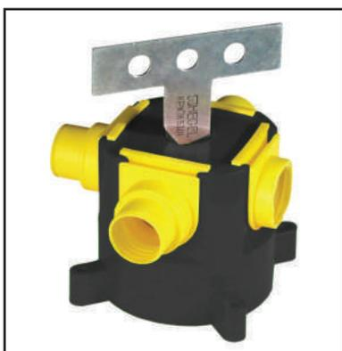
Коробку можно использовать в качестве потолочной для подвески и подключения светильников. Для этого надо в нее установить Крюк 5301 (см. раздел «Аксессуары»), сделав ножом в дне коробки с внешней стороны по уточнению сквозной прорез длиной 20 мм. С усилием вставить крюк в дно коробки. Затем одеть изолятор на крюк. Максимальная нагрузка на крюк – 15 кг.
