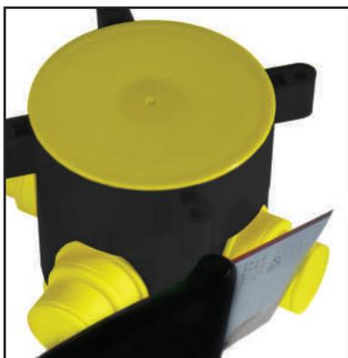
Выбрать, через какие гермовводы будет вводиться труба и ножом обрезать их по линии отреза под диаметр трубы 20 или 25 мм.
