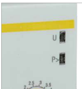
Световой индикатор показывает состояние сети.
