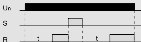
Диаграмма работы реле задержки включения ORT-A
