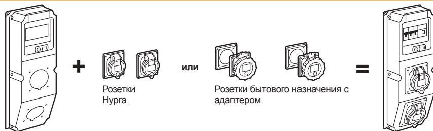
Щиток с отверстиями
