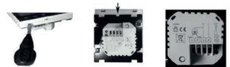
Чтобы вскрыть терморегулятор, поместите конец плоской отвертки в обе разъемы в основании терморегулятора.
