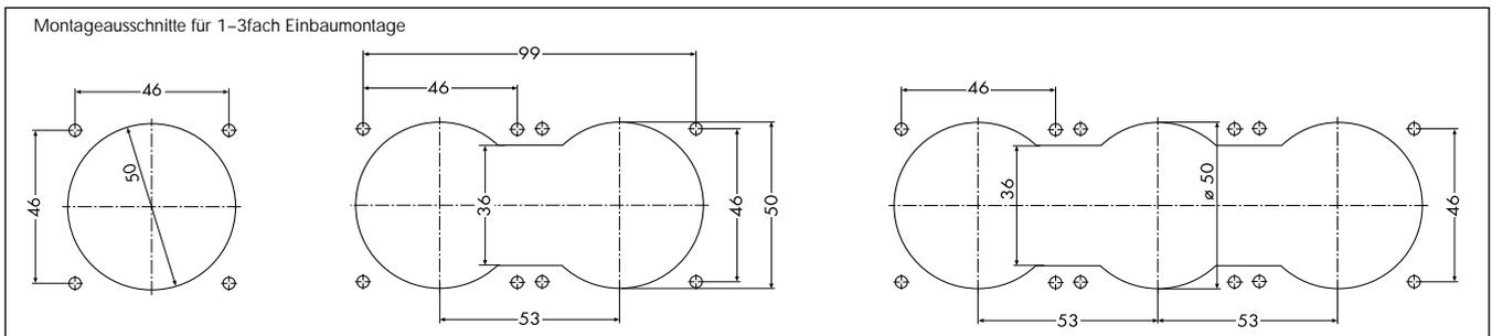
Die Ausschnittvermaungen zeigen deutlich: Selbst da, wo es eng wird, findet sich immer noch Platz fur COMPACTA. Die Montage erfolgt – wie bei allen anderen PEHA-Produkten – problemlos. Anders als bei der herkommlichen Installation wird beim Einbauprogramm z. B. ein Schalter direkt mit dem Untergrund verschraubt. Die zuvor aufgesetzte Dose hat lediglich Isolierfunktion. Als letzter Handgriff wird die Rahmenplatte auf den Schalter gesteckt. Einfacher geht es nicht!
