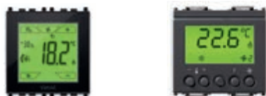
02952 Электронный термостат с сенсорным экраном для контроля температуры в 2 зонах по отдельности, стандарт KNX, 1 НР релейный выход 4 А 24 В~, 1 вход для подключения датчика температуры или 02965, 1 программируемый цифровой вход - 2 модуля. При монтаже использовать специальную монтажную рамку 16723. Глубина: 38,5 мм 16915 Термостат для регулирования температуры окружающей среды в 2 независимых зонах (отопления и кондиционирования). Стандарт KNX, релейный выход NO (нормально открытый) 4 А 24 В~ + 1 вход для датчика температуры + 1 программируемый вход - 2 модуля. Глубина: 36,5 мм
