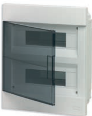
V52424 24 модуля, в комплекте с DIN-рейкой (60715 TH35), белый RAL 9003, с затемненной прозрачной дверцей. Рассеиваемая мощность: 58 W
