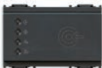
16927 Устройство чтения карт- транспондеров для уста- новки вне помещения, стандарт KNX, 2 релейных нормально разомкнутых выхода 4 А 24 В~, 2 входа, 12-24 В~ 50/60 Гц и 12-24 В пост. тока (SELV) - 3 модуля. Поставляется без карты-транспондера. Глубина: 36,5 мм
