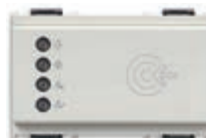
16927.B Устройство чтения карт- транспондеров для уста- новки вне помещения, стандарт KNX, 2 релейных нормально разомкнутых выхода 4 А 24 В~, 2 входа, 12-24 В~ 50/60 Гц и 12-24 В пост. тока (SELV) - 3 модуля. Поставляется без карты-транспондера. Глубина: 36,5 мм
