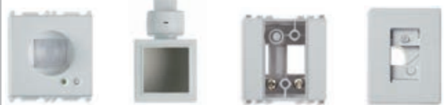
14850.SL ИК-детектор присутствия, стандарт KNX - 2 модуля. Глубина: 19 мм 00802.20 Ориентируемый суппорт - 2 модуля 00805.20 Адаптер для ориентируемого суппорта, встраиваемый монтаж - 2 модуля. Глубина: 36,5 мм 00800.20 Каркас для ориентируемого суппорта Δ 16831.SL Как выше
