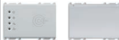
14457.SL Устройство чтения карт-транспондеров для установки вне помещения, стандарт KNX, 2 релейных нормально разомкнутых выхода 4 А 24 В~, 2 входа, 12-24 В~ 50/60 Гц и 12-24 В пост. тока (SELV) - 3 модуля. Поставляется без карты-транспондера. Глубина: 36 мм 14453.SL Устройство чтения карт-транспондеров с вертикальным карманом для установки в помещении, стандарт KNX, 2 релейных нормально разомкнутых выхода 4 А 24 В~, 2 входа, 12-24 В~ 50/60 Гц и 12-24 В пост. тока (SELV) - 3 модуля. Глубина: 36 мм
