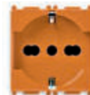
14210.AB.A Розетка SICURY 2P+T 16 А 250 В~, универсальный, оранжевый - 2 модуля. Глубина: 25 мм
