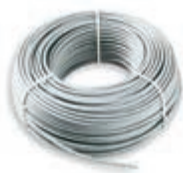
01840 Кабель для системы Bus, безгалогенный, 2x0,50 мм 2 , обеспечивает изоляцию от земли для номинального напряжения 300/500 В и, следовательно, пригодный для укладки в одном коробе с кабелями I категории, белая - 100 м
