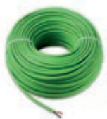
732I/100 Кабель Due Fili Plus для внутренней/наружной прокладки, проводники с витыми парами 2x1 мм 2 , изоляция и оболочка LSZH (малодымный безгалогенный компаунд), рабочая температура -25/+70 °C, класс изоляции 600/1000 В, пригоден для подземной прокладки в сухих трубах или трубах с дренажом (макс. время нахождения в мокром состоянии 24 ч), непригоден для прокладки непосредственно в земле - моток длиной 100 м
