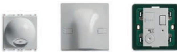
14046.SL² Кабельный ввод 20 А с клеммной коробкой. Глубина: 22,1 мм 14047.SL² Кабельный ввод 45 А с клеммной коробкой. Глубина: 20 мм 14049.SL³ Соединительный блок 13 А с выключателем и предохранителями. Глубина: 20,4 мм
