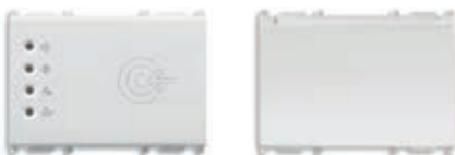
14457 Устройство чтения карт-транспондеров для установки вне помещения, стандарт KNX, 2 релейных нормально разомкнутых выхода 4 А 24 В~, 2 входа, 12-24 В~ 50/60 Гц и 12-24 В пост. тока (SELV) - 3 модуля. Поставляется без карты-транспондера. Глубина: 36 мм 14453 Устройство чтения карт-транспондеров с вертикальным карманом для установки в помещении, стандарт KNX, 2 релейных нормально разомкнутых выхода 4 А 24 В~, 2 входа, 12-24 В~ 50/60 Гц и 12-24 В пост. тока (SELV) - 3 модуля. Глубина: 36 мм
