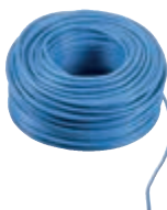
732H/100 Кабель Due Fili Plus для внутренней прокладки, проводники с витыми парами 2x1 мм 2 , ПВХ оболочка, рабочая температура -25/+70 °C, класс изоляции 450/750 В, не предназначен для прокладки в подземном лотке - моток длиной 100 м
