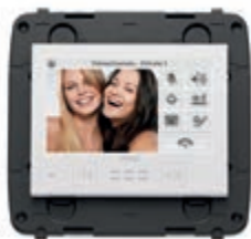
21554.B Сенсорный видеоскрэн 4,3" Full Flat, для внутреннего поста системы видеодомофони Due Fili Plus, служащий для контроля и управления, вход для подключения датчика температуры, с держателем для установки в коробки на 8 модулей. Глубина: 46,7 мм
