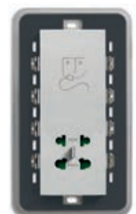
20291.N 6 230 В~ 50/60 Гц, с разделительным трансформатором 20 ВА, 230 В~ и 120 В~ выходы. Глубина: 41 мм
