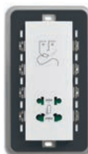
20291.B 6 230 В~ 50/60 Гц, с разделительным трансформатором 20 ВА, 230 В~ и 120 В~ выходы. Глубина: 41 мм
