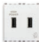
20295.B Блок питания 5 В 2,1 А, 2 USB-выхода с общим током 2,1 А, 120-230 В~ 50/60 Гц - 2 модуля. Глубина: 37 мм
