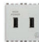
20295.N Блок питания 5 В 2,1 А, 2 USB-выхода с общим током 2,1 А, 120-230 В~ 50/60 Гц - 2 модуля. Глубина: 37 мм
