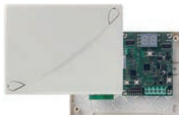
01729 Двусторонний радиочастотный интерфейс, 868 МГц
