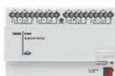
01525 Актуатор для управления 8 жалюзи с релейными выходами 6 А 230 В~ 50/60 Гц, стандарт KNX, 8 модуля x 17,5 мм
